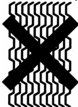
Рисунок Б.2 – Вид пакета пластин при правильной сборке
