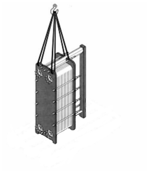
Строповка теплообменника с транспортировочными отверстиями
