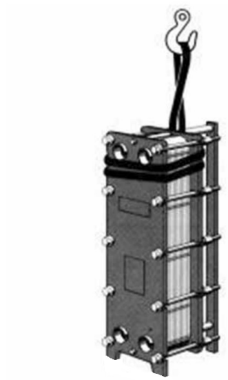
Строповка теплообменника без транспортировочных отверстий
