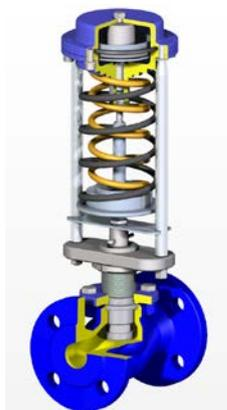
Регулятор предназначен для автоматического поддержания заданного давления рабочей среды в трубопроводе до регулятора (по ходу движения рабочей среды). Клапан регулятора при отсутствии давления нормально закрыт. При повышении давления до регулятора клапан открывается.
