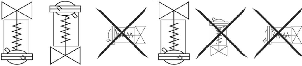
Монтажные положения регулятора на трубопроводе при температуре среды **до 100°С**.
