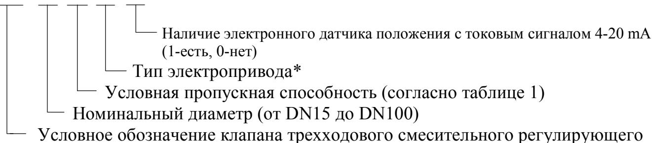
\* 1-привод STmini, согласно таблице1 (скорость перемещения поршня-10 мм/мин)
