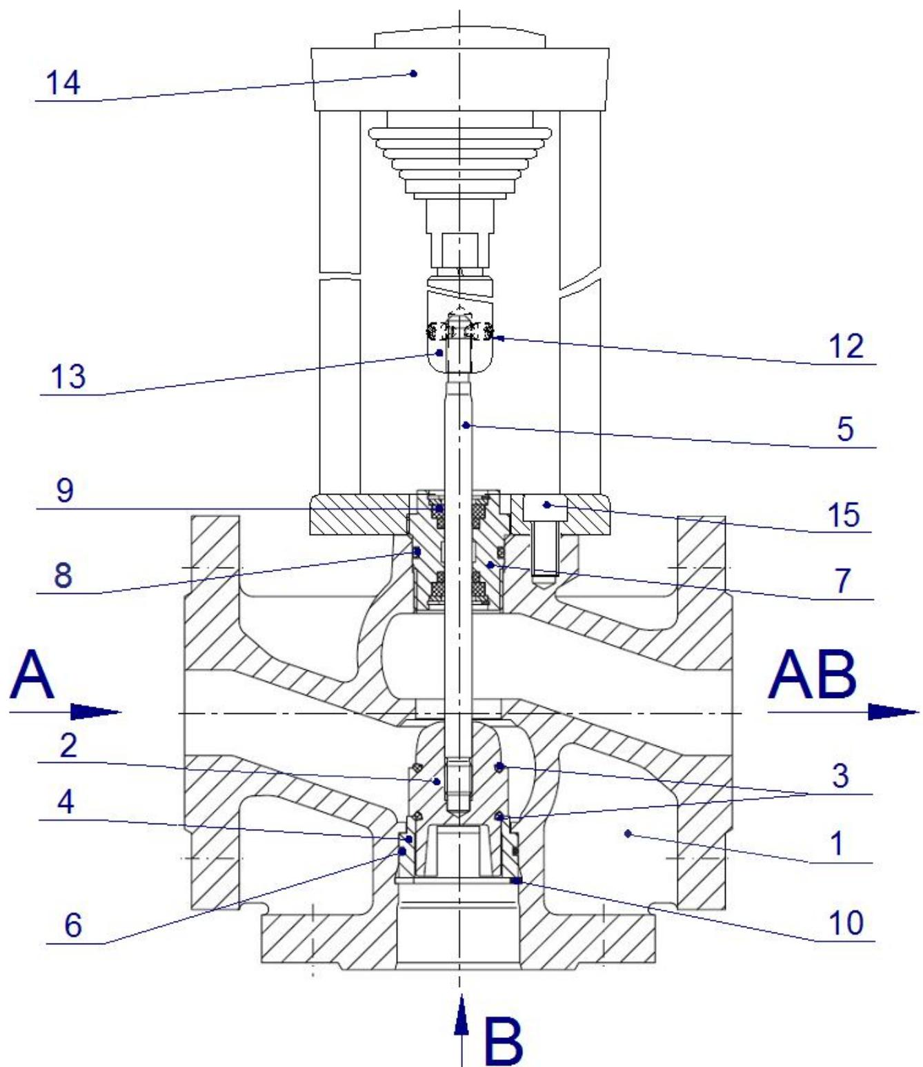
Рисунок А.1 Устройство клапана с приводом ST MINI
