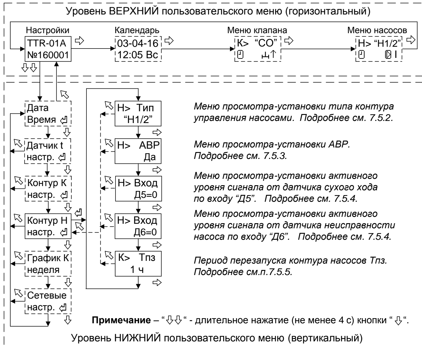
Рисунок 9 - Структура меню настройки параметров контура управления насосами.
